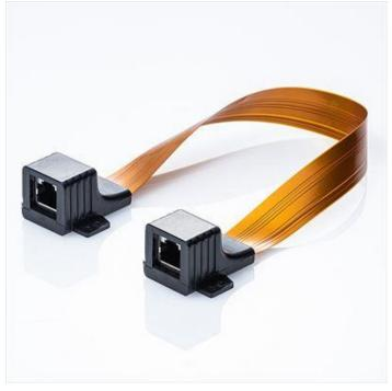
本製品は、屋外から屋内へ LAN ケーブルを引き込める、すきま用 LAN ケーブルです。窓やドアの隙間を利用するので、壁に穴を開けずに LAN ケーブルを引き込めます。RJ-45 メスコネクタと RJ-45 メスコネクタを使用した、中継タイプで、ケーブルの厚みは約 0.25mm の超薄型フラットケーブル仕様です。コネクタ部からコネクタ部までの長さは、約29cmです。エンハンスドカテゴリ 5e 相当の仕様で、家庭やオフィス、倉庫や防犯カメラの設置などに最適です。コネクタ部取付用の両面テープと木ネジを付属しています。
