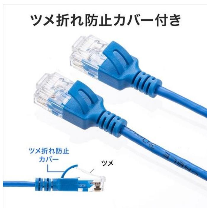
本製品は、10 ギガビットイーサネットに対応した CAT6A 仕様の LAN ケーブルです。500MHz の伝送帯域で高速転送が可能なので、カテゴリ 6 の 2 倍の伝送帯域を実現しています。50cm/1m/2m/3m/5m/10m/と長さバリエーションがあり、パソコンの周りはもちろんのこと、液晶テレビやレコーダーなど様々な場面で使用することができます。直径 3mm の柔らかく取り回しがしやすいケーブルで、コネクタ部分もツメ折れ防止カバー付きスリムコネクタを採用しており、機器への抜き差しも楽に行えます。
