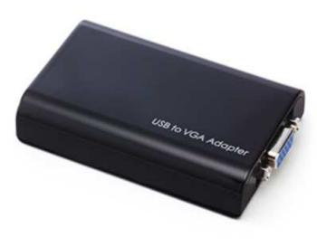
本製品は、パソコンの USB ポートから VGA 出力が可能、ディスプレイ等を増設できるアダプタです。VGA のインターフェースを持たないパソコンでも映像を外部出力する事ができます。重量が約 56g、幅が 54mm で奥行きが 88mm の軽量・コンパクトサイズなので、外出先などでも使用する事ができます。出力表示モードは拡張モードと複製モードの 2 つのモードを搭載しています。一般的な外部ディスプレイのように、Windows の標準設定から拡張モードで操作領域を増やしたり、複製モードを使用して複数人で同じ画面を共有する事ができます。例えば、画面の小さいノートパソコンから大画面のテレビやディスプレイを増設できるので、操作性が上がります。解像度は最大でフル HD まで対応可能です。ソフトウェア上のメニューからディスプレイの設定が可能で、解像度や表示モードの選択、画面の回転等の設定ができます。電源は USB から供給するバスパワーで、別途 AC アダプタ等は必要なく手軽に使用できます。
