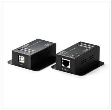
本製品は、パソコンと USB 機器間を最大 50m まで延長することができる USB2.0 エクステンダーです。受信機には 2 台の USB 機器を接続できる、2 ポートハブ付きです。送信機と受信機の間にカテゴリー5/5e の LAN ケーブル 1 本を使用して延長できます。一般的な USB ケーブルでは届かない、離れた場所にあるプリンターや USB 接続ハードディスクドライブなどと有線で接続したい場合に最適です。カメラから離れた場所で、パソコンモニターを確認しながら撮影するテザー撮影などにも便利です。ソフトウェアのインストールなどは不要で、接続するだけですぐにご使用いただけます。カテゴリー5/5e ケーブルを使用するので取り回しが簡単で、コストパフォーマンスにも優れています。壁固定などが可能な壁面取り付け穴付きです。電源は送信機側から LAN ケーブルを通して供給されるので、受信機側に電源を必要としません。
