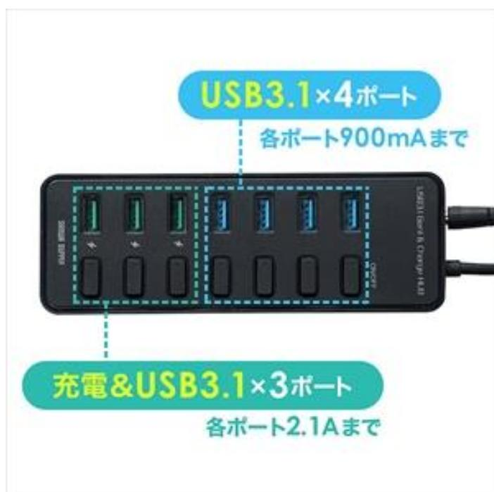
本製品は、個別スイッチを搭載した7ポートハブです。パソコンで使用する周辺機器を接続し使用することができます。また、7ポート中3ポートは、充電機能も搭載しており、スマートフォンやタブレットの充電もすることができます。パソコンの電源を落としても、各3ポートともに2.1Aの充電器としてご利用頂けます。待機電力をカットする個別スイッチを搭載し、機器の過充電の防止、一目で通電の有無が確認できます。
