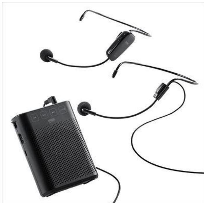
本製品は、ワイヤレスと有線のヘッドマイク付属で、2人同時に音声出力できるバッテリー内蔵のポータブルワイヤレスマイクです。マイク部とスピーカー部がワイヤレスなので、スピーカーを常に正面に向けたまま固定でき、自由に移動しながら、ハンズフリーで発言や作業ができます。教卓などに設置し向きを固定した状態で自由に移動ができるので、聴く側も安定した聞き取りが可能です。軽量でコンパクトサイズながら最大10Wの高出力で、講義や講演、店頭販売、街頭演説、ツアーコンダクター、スポーツインストラクターなどに最適です。ワイヤレスマイクはB型帯域に割り当てられた60波の中から1波を自動選択され、周波数が重なった場合も手軽に変更が可能です。同じ部屋や同空間内での複数台を使用した環境でも混信することはありません。有線ヘッドマイクも同梱しておりスピーカー本体へ直接ヘッドマイクを接続しての使用も可能で、有線ヘッドマイク・ワイヤレスヘッドマイクの同時利用もできます。防災時などでも活用できる、FMラジオを内蔵しています。USBメモリやmicroSDカードに保存されたMP3音楽データを再生可能です。
