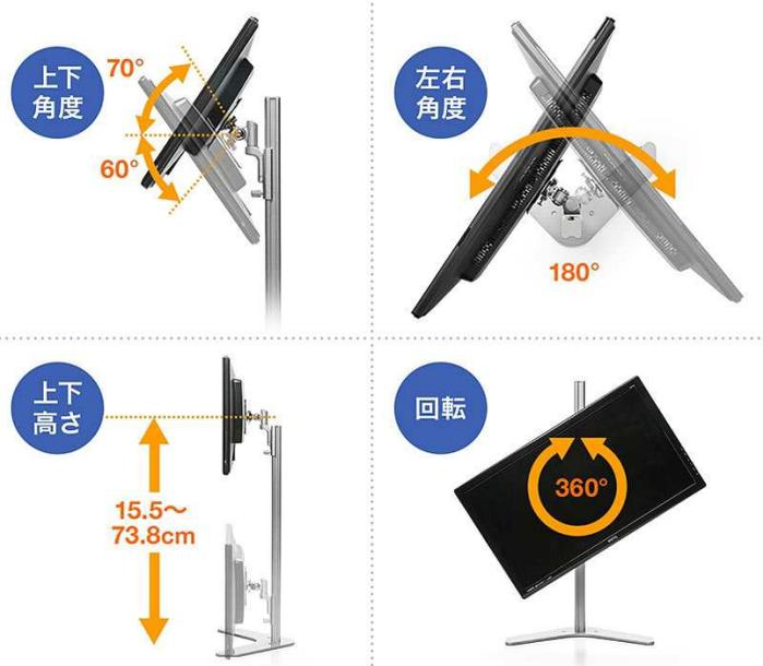
本製品は、デスクの天板に置いて使用するモニタースタンドです。VESA 規格 100×100、75×75 に対応し、6kg までのモニターを取り付けることができます。クランプ式で取り付けるタイプとは違い、天板のサイズや厚みを気にすることなく使用できるので、置きたい所へ置くことができます。上へ 70°、下へ 60° の角度調整、高さも 15.5～33.8cm
