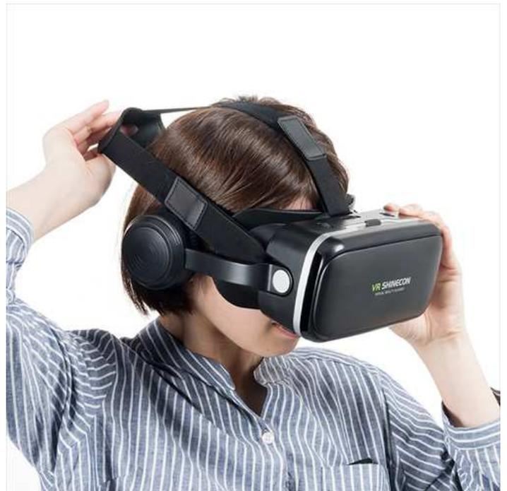
本製品の 400-MEDIVR7 は、iPhone やスマートフォンなどを VR ゴーグルにセットすることで、3D 映像や VR 映像を鑑賞することができる VR ゴーグルです。4～6 インチのスマートフォンに対応しており、挟み込むだけの簡単取り付けで、対応サイズの様々なスマートフォンを取り付けることができます。また、ヘッドホン付きの為、VR ゴーグルに付属している 3.5mm ステレオミニプラグをスマートフォンに挿し込むことで、スマートフォンの音声を臨場感溢れる形で聴きながら映像をご覧いただくことができます。ゴーグルを装着したまま再生、停止操作ができるマルチボタン、ボリュームの調整ができるボリュームボタンを兼ね備えており、わざわざゴーグルを外す必要がなく、操作することが可能
