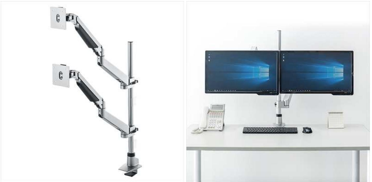
本製品は、上下2画面、左右2画面の設置に対応し、アームがそれぞれ独立して動作する為、それぞれのモニター的位置を調整することができます。ガスの圧力とモニターの重さで固定するガスシリンダー内蔵で、無段階で調整が可能です。（※完全固定ではありません）目線の高さに合わせての上下調節や、前後調整が行えます。画面の角度調整は上下に約140°、左右に約180°調整できます。画面は左右に90°（合計180°）回転が可能です。第二関節は360°回転が可能です、第一関節部は120°調整が可能です。アーム部分をポールにスライドさせることで、モニターを任意の高さに調整できます。アームを1つ取り外すと、1面だけの使用も可能です。アーム部分には、ディスプレイからのケーブルをすっきり配線できるケーブル受けを装備しています。VESA規格（75×75mm、100×100mm）に準拠した液晶ディスプレイの取り付けが可能です、ブラケットを取り外すことができ、モニターを設置する際の取り付けが楽に行なえます。デスク取り付けは、設置が簡単でスリムなクランプ式と、天板にネジ穴を上げて固定するグロメット式にも対応していま
