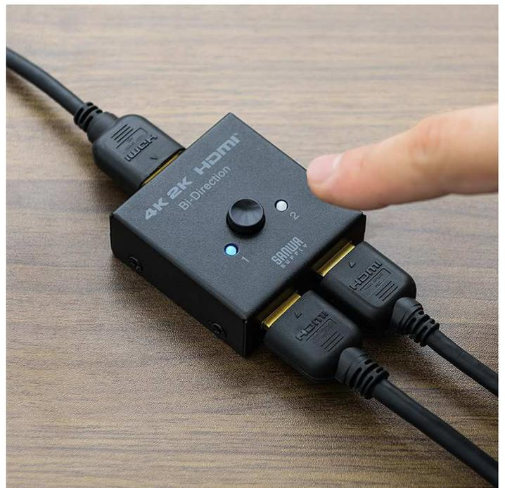
本製品は、4K/30Hz 対応で、セレクトスイッチで簡単切り替えが可能な手のひらサイズの 2 入力 1 出力または、1 入力 2 出力の双方向に切り替えできる HDMI セレクターです。4K/30Hz の高性能な再生機器から映し出される美しい映像をそのままに、大画面の液晶テレビやディスプレイに出力できます。
