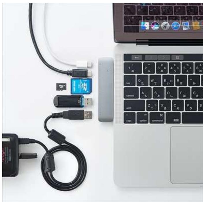
本製品は、MacBook Pro専用のカードリーダー付きUSB Type-Cハブです。Type-CポートしかないMacBookに、USBメモリやUSBマウス等の機器やメモリを接続でき、2種類までのUSB機器の接続が可能です。Thunderbolt 3対応のUSB Type-Cポートを1ポート搭載し、USB Type-C接続のディスプレイやUSB Type-Cメモリなどの接続ができます。また対応するディスプレイに接続すれば、4Kを超える最大5Kまでの高解像度の出力が可能です。87W USB PDに対応し、Apple純正ACアダプタを使用時のMacBookに接続したままの充電が可能です。他に、通信専用のUSB Type-Cポート、SD/microSDカードスロットを搭載しています。本体への接続は、ハブ本体のぐらつきを抑え安定した接続が可能な2ポート接続です。デザインはアルマイト処理されたアルミ製ボディで、スッキリと接続できるケーブルレスタイプです。
