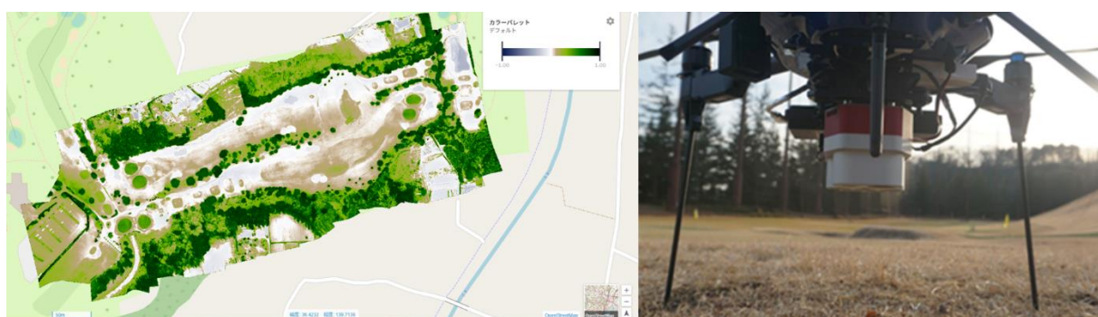
ドローンによる芝育成状況可視化解析結果の画像（左） ドローンに装着した多波長カメラ（右）
