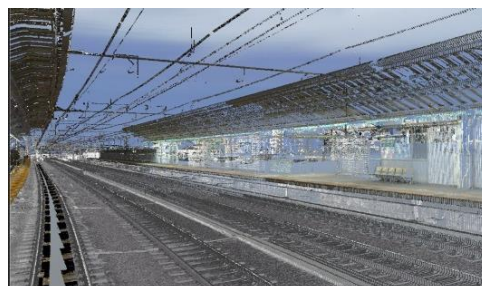
▲実証実験で取得した3次元点群データ（二子新地駅）
