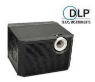
TED では、2016 年 10 月に超高速プロジェクタ 「DynaFlash」を発売し、高速の投影制御技術による移動体へのプロジェクションマッピングを用いてさまざまな研究システムの開発に携わってきました。超高速プロジェクタ「DynaFlash」は、モノクロ時/Max 1000fps8bit 階調、カラー時/Max 925fps24bit 階調で投影が可能になり、Texas Instruments 社 DLP® DMD (Digital Micromirror Device) と高輝度 HLD 光源を用いて、独自の FPGA による高速制御回路で高いフレームレートによって、ウォーターパール・プロジェクションマッピングを実現しています。
