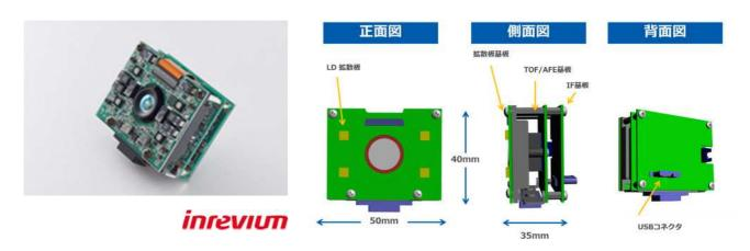
現在、スマートフォンやゲーム機などに採用されているTOF (Time Of Flight)方式による3次元計測は、 ドローンやロボット、車などへの採用も検討されるなど、関心の高い技術です。
