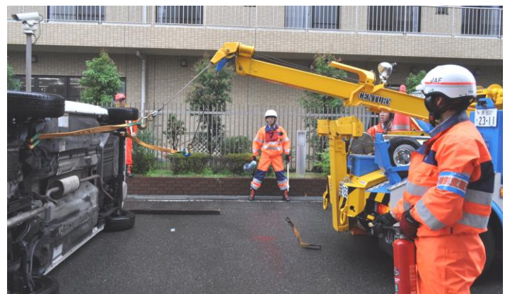
横転車両の引き起こし・排除作業
