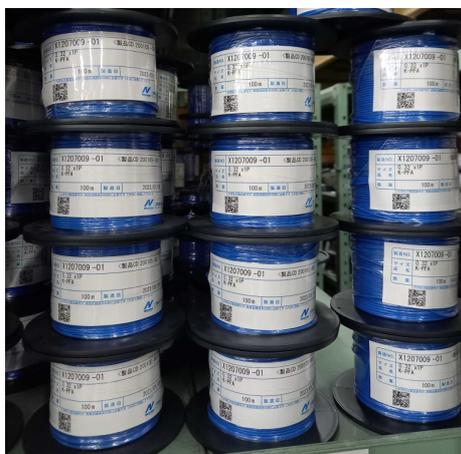
熱電対線を巻いたプラスチック製のポビン（写真提供：二宮電線工業株式会社）
